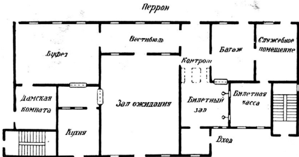
фиг. 131. План пассажирского здания средней величины.
