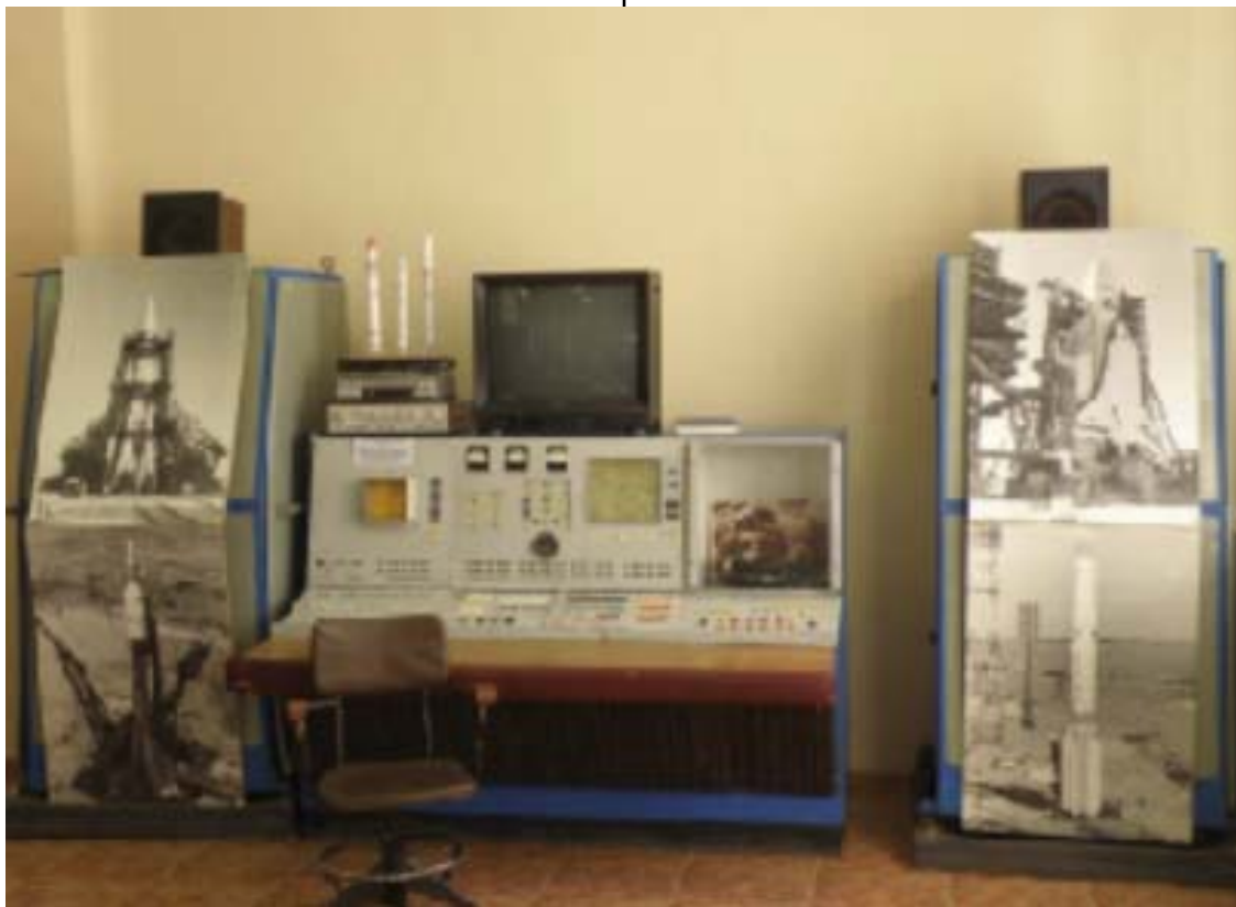
Елементи тренажерного комплексу КК «Союз», призначеного для підготовки космонавтів
