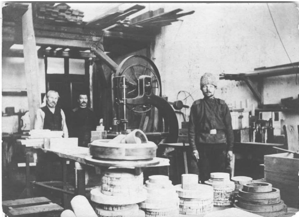
Механічні майстерні КПІ. Виготовлення калібрів та шаблонів для снарядів. 1915-1916 роки
