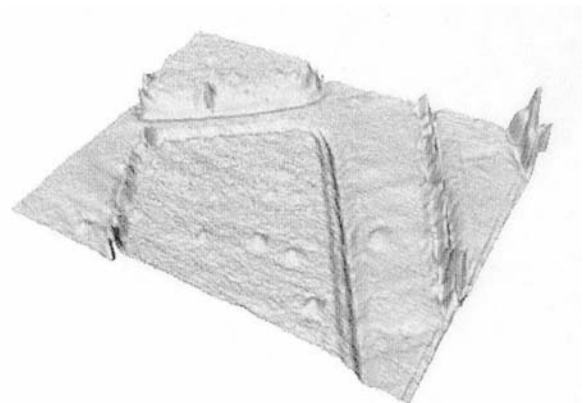
Тривимірна поверхня зразка, отримана за допомогою комп'ютеризованого мікроінтерферометра Лінника АІМ.
