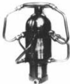
Рис. 4 . Дослідний двигун ОРМ-52 конструкції В. П. Глушка, розроблений в Газодинамічній лабораторії (ГДЛ) в 1933 р. в Ленінграді для експериментальних ракет, морських глибуючих торпед, літаків. Паливо - азотна кислота і газ
